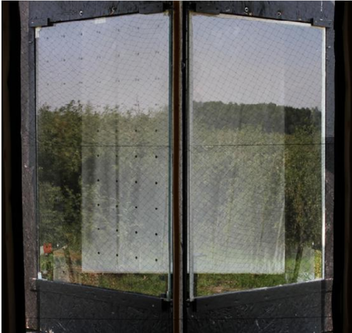
Abbildung 3: Prüfscheibe „Punkte 9mm“ (links) und unmarkierte Referenzscheibe (rechts) im WIN-Test. Die Prüfung dieser Markierung wurde 2018 durchgeführt.
