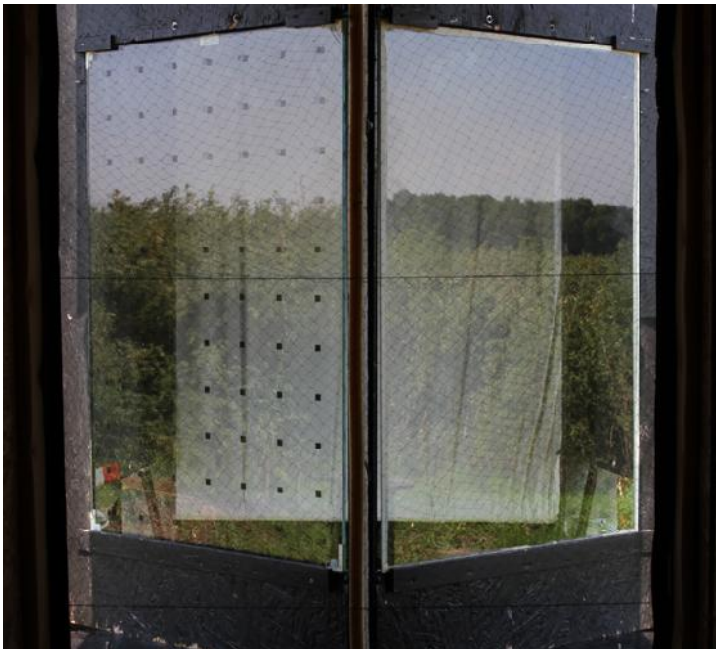
Abbildung 4: Prüfscheibe „Quadrate 12mm“ (links) und unmarkierte Referenzscheibe (rechts) im WIN-Test. Die Versuche wurden 2018 begonnen und 2019 abgeschlossen.
