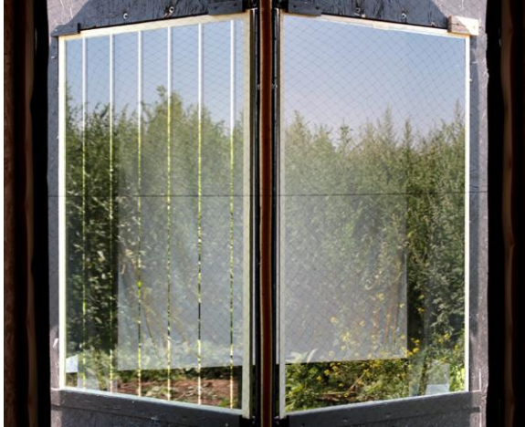
Abbildung 4: Liniendesign vertikal 5/95. Chrom-metallische vertikale Streifen auf Position 1.
