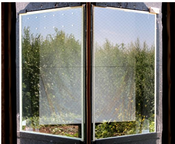
Abbildung 5: Punktraster „Dart“ 9/90. - Chrom-metallischer Raster durchbrochener Punkte auf Position 1
